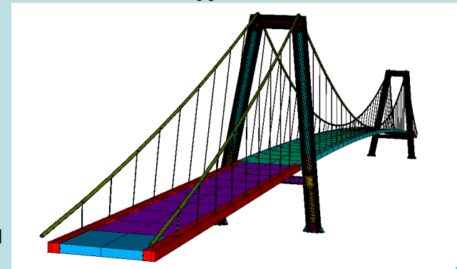
Výpočtový model konstrukce mostu MKP 30 tis. stupňů volnosti
